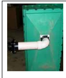
Fig. 5 Attach Dump Valve
